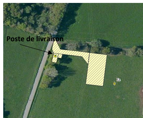
Figure 27 : Localisation du poste de livraison
